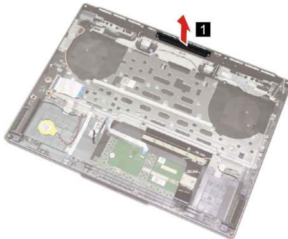
Figure 40. Remove the thermal fin
